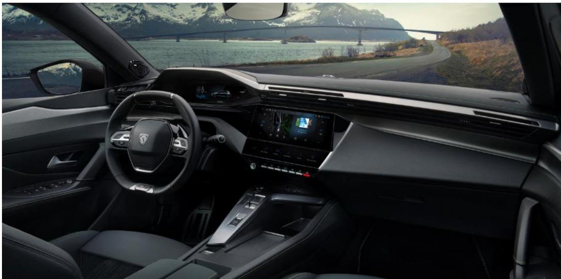
La costruzione della plancia di Nuova PEUGEOT 308 è basata sull'architettura "high-vent" che posiziona i diffusori della climatizzazione di fronte alla testa degli occupanti, un'ubicazione ottimale per il comfort del conducente e dei passeggeri. Quest'architettura permette al touchscreen centrale di serie (da 10 pollici e
