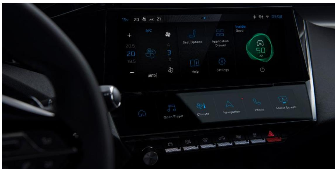
Il design della consolle centrale riflette il guadagno di spazio ottenuto grazie al nuovo blocco compatto della climatizzazione. Il nuovo design ha permesso di raggruppare su un arco dal lato del conducente tutti i comandi dinamici della vettura:
